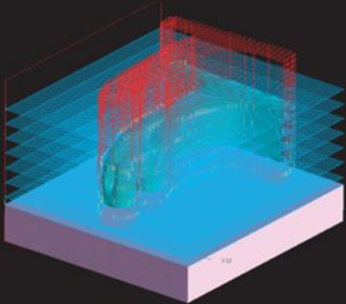
測定からCADへ変換後金型作成の為
